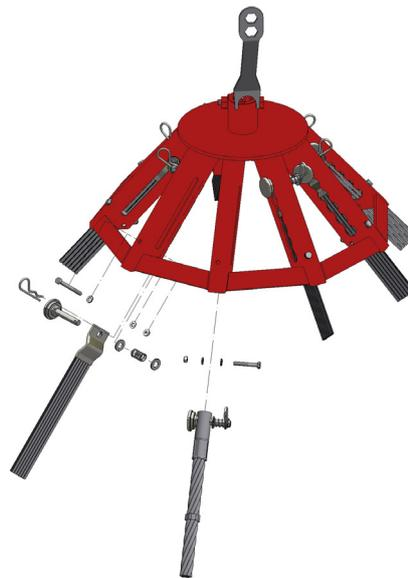
La brosse de sarclage peut travailler avec deux types de brosses différents. La brosse en acier plat (standard) et la brosse en fil de fer. Si l'on souhaite passer de la brosse plate à la brosse en fil de fer, le boulon de mécanique M6x60 qui se trouve au fond du profil de la brosse doit être dévissé et un nouveau boulon de mécanique M6x40 doit être fixé à travers l'autre trou Ø7 du profil de la brosse avant que la brosse ne soit insérée.
