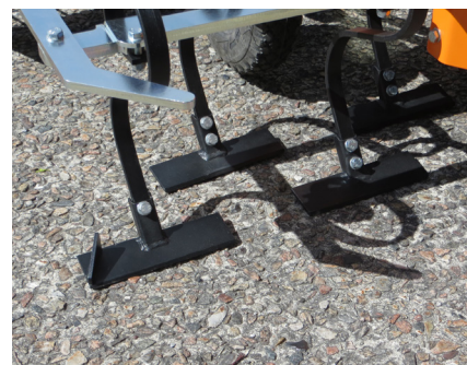
Dents avec pièces d'usure
