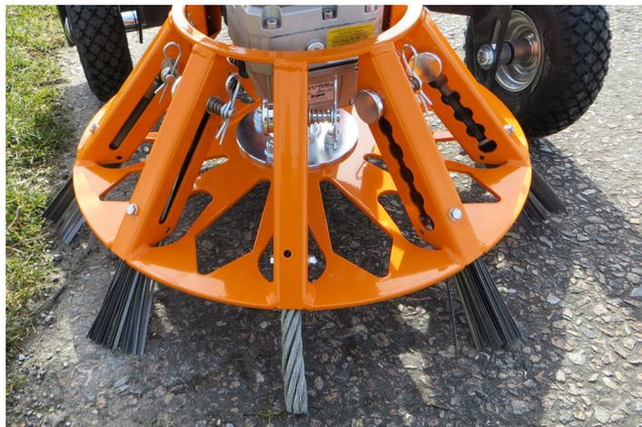
La brosse de sarclage peut être utilisée avec deux brosses différentes: la brosse en acier plat et la brosse en fil de fer. Si vous souhaitez remplacer la brosse plate par la brosse en fil de fer, dévissez la vis d'assemblage M6x60 qui se trouve au fond du profil de la brosse, et fixez une nouvelle vis d'assemblage M6x40 à travers l'autre trou de diamètre 7 sur le profil de la brosse avant d'insérer la brosse.
